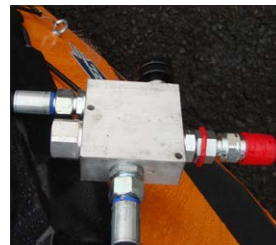
Durchflussregler für Streumenge
