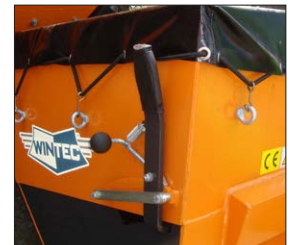
Grundeinstellung mit Hebel
